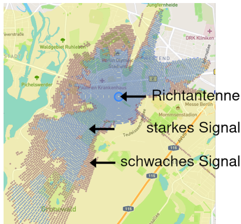
Abbildung: Abdeckung einer Richtantenne aus im Praxisprojekt entwickelter Simulationsanwendung
